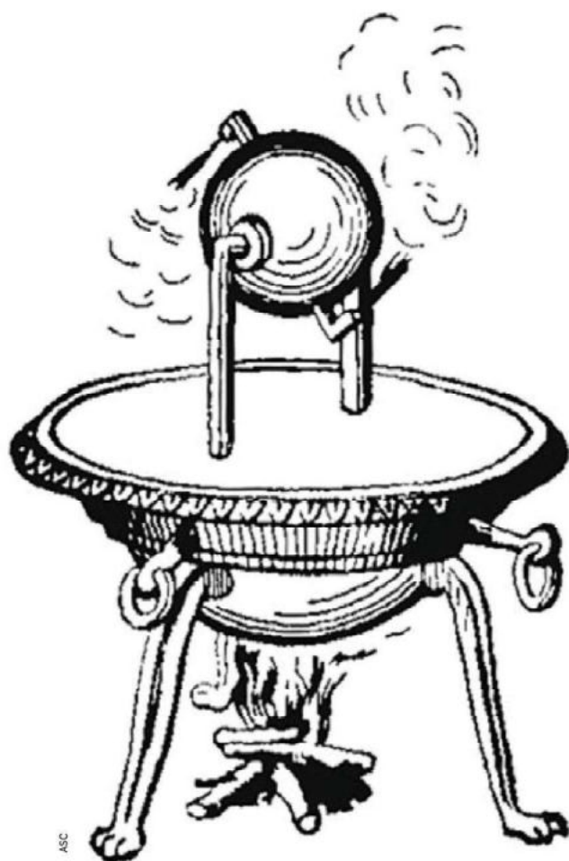
Ilustración de una eolípila de Herón de Alejandría. Se considera la primera máquina térmica de la historia, dos mil años antes de su utilización.
