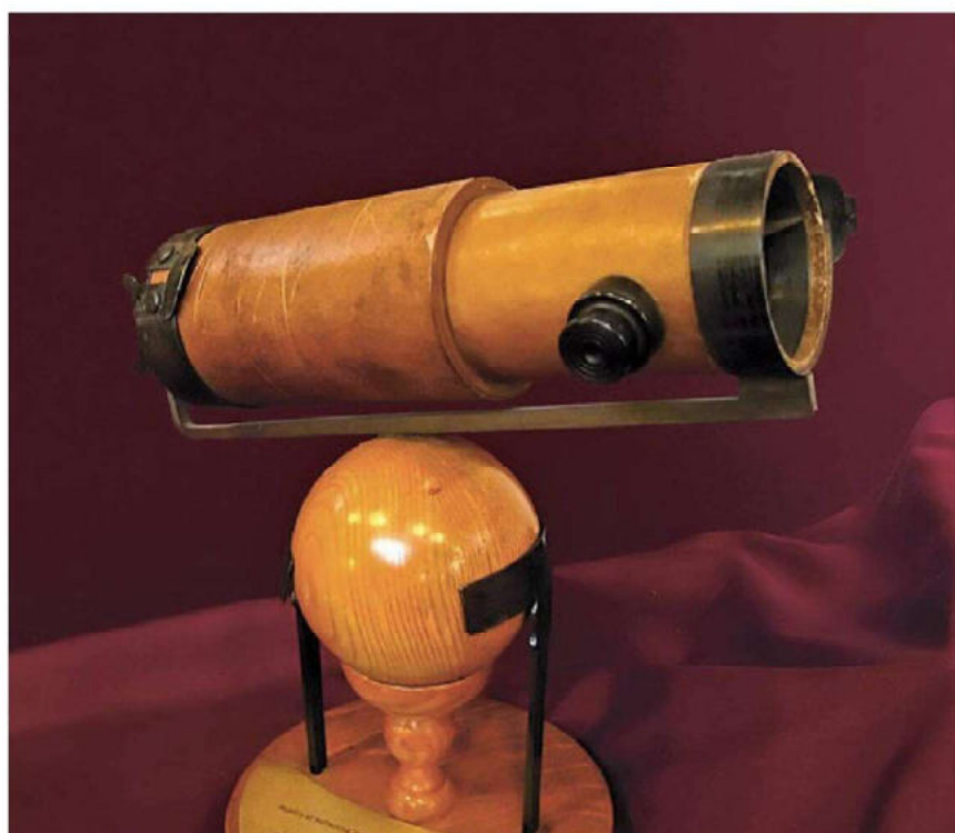
Réplica de un telescopio construido por Newton. Conocido como telescopio newtoniano, es el primer telescopio reflector funcional de la historia.
